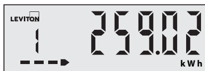
Figure 7 – Exemple d'écran en mode de fonctionnement normal
