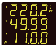
Fig 4-3 Multifunction Display (AcuDC 243)
